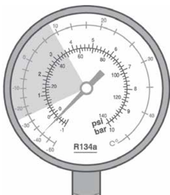
Bassa pressione insufficiente
