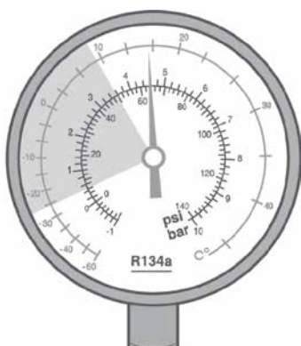
Bassa pressione troppo elevata
