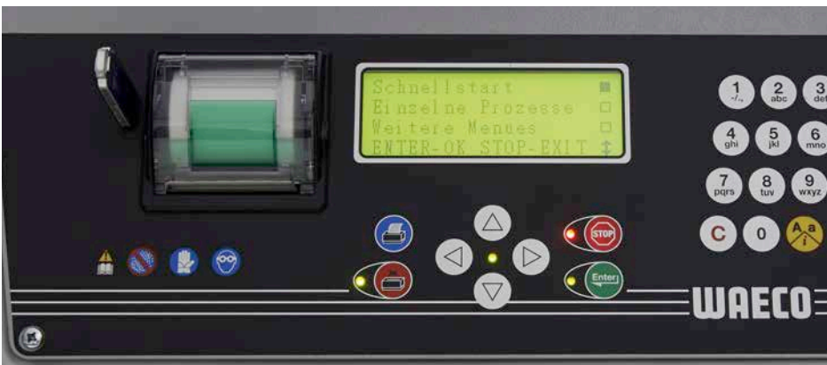
NOVITÀ: Interfaccia USB per aggiornamenti del software e della banca dati e per la documentazione dei dati di servizio; il display grafico mostra anche i caratteri speciali
