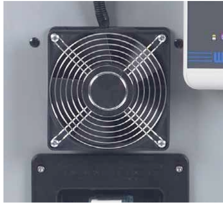
Sicurezza: doppio monitoraggio della ventola a controllo elettronico
