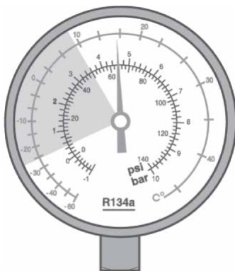
I manometri del lato bassa pressione e alta pressione mostrano lo stesso valore.
